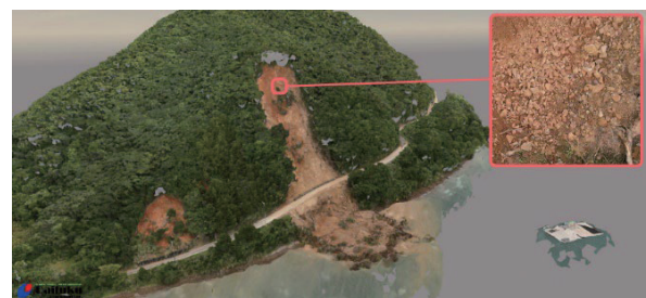
図8 PPK×オブリーク撮影による三次元テクスチャモデル
